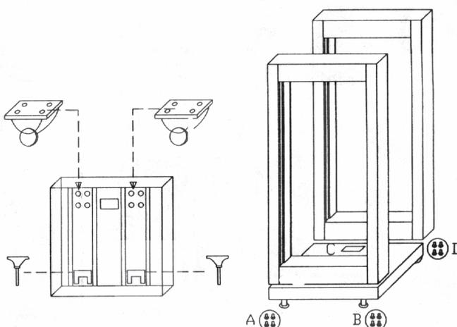
1) Соберите нижнее основание шкафа. Для этого закрепите подвижные ролики (для моделей PR-151NA, PR-231NA, PR-271NA, PR-331NA, PR-391NA, PR-401NA, PR-451NA) и опорные ножки на одной из платформ с помощью крепления, входящего в комплект. Далее установите переднюю и заднюю панель на нижнее основание и закрепите их.
